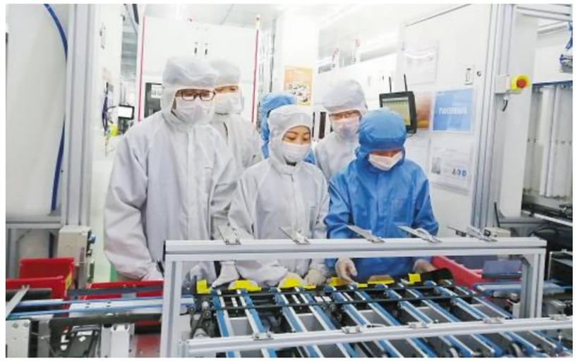
成都公司车间标准化设备保养技改工作现场,员工检查自动化下料皮带
