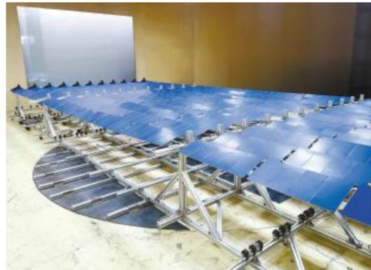
通威柔性支架通过行业最为严苛的空气动力学试验检验
